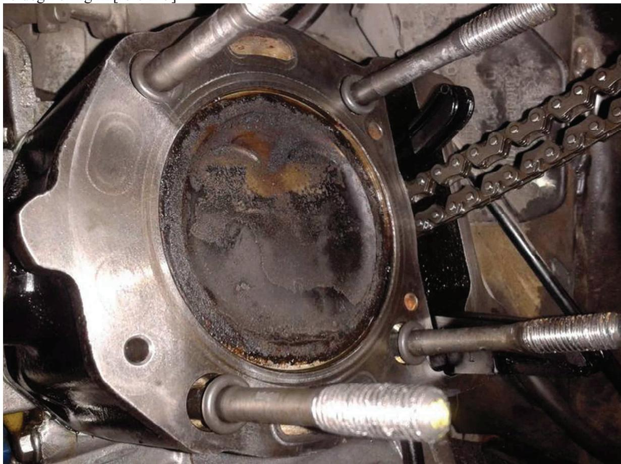
ripulita la base del cilindro ed i carter motore ho iniziato a rimontare inserendo la nuova guarnizione [foto n° 6 - confronto tra le due guarnizioni]
